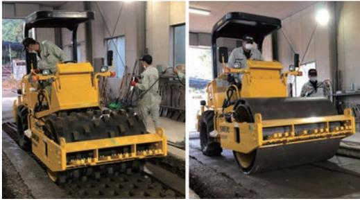
写真-1 縮固め試験状況 (左: SVT-5t, 右: SVF-5T)
