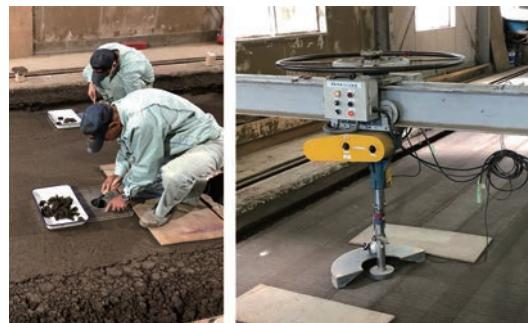
写真-2 測定状況 (左: 砂置換法、右: CBR)
