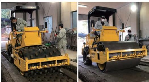
写真-1 締固め試験状況 (左: SVT-5t、右: SVF-5t)
