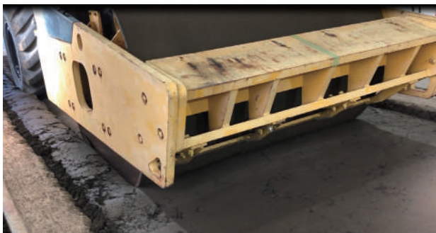
写真-3 SV-20t (条件:w3) 【走破性判定:×】
