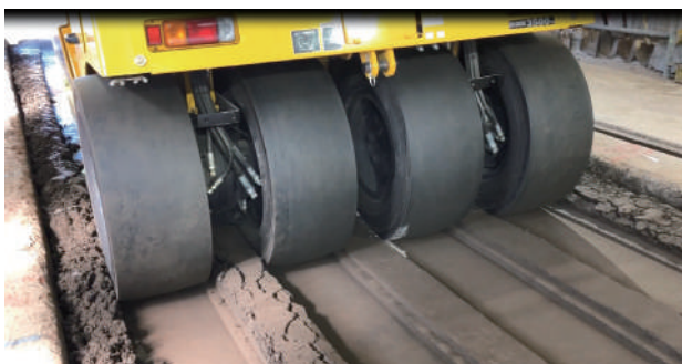
写真-4 TZ-12t (条件:w2) 【走破性判定:△】
