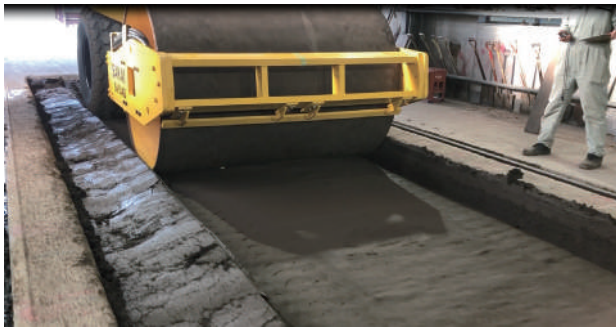
写真-2 SV-12t (条件:w3) 【走破性判定:○】
