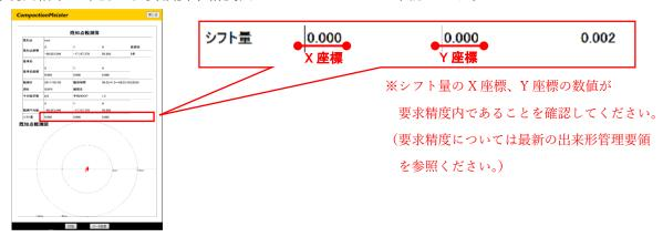
※アンテナ単体での既知点観測による平面位置の確認が、車体の傾き等の誤差を受けず、最も正確に アンテナの精度を確認する事が可能です。また、サーバー上にデータを残す事が出来ます。
