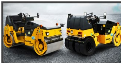
タンデムローラ(左)・コンパインドローラ(右) 市街地の中小型舗装工事に使用
