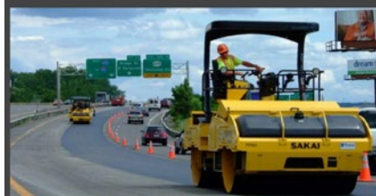
大型舗装用振動ローラ 主に高速道路などのアスファルト舗装工事に使用 アメリカ、中国等の大規模舗装工事に需要多い
