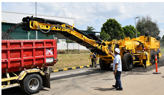
サカイ・インドネシアは東南アジア向けに投入するロードカッター「E R 555 F—s」のデモンストレーションを披露した = 6日、西ジャワ州（NNA撮影）
