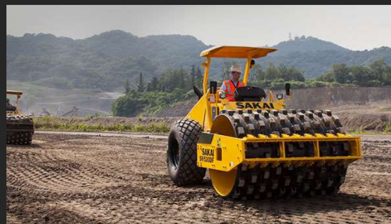
大型土工用振動ローラ 道路基礎工事、造成・ダム等の大型土木工事に使用
