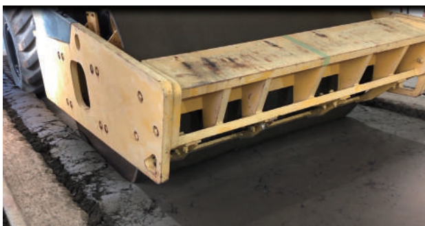
写真-3 SV-20t (条件:w3) 【走破性判定:×】
