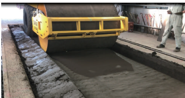
写真-2 SV-12t (条件:w3) 【走破性判定:○】
