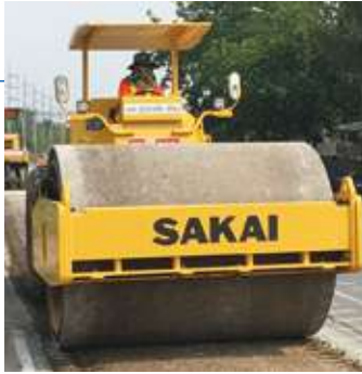
タイの工事風景：土工用振動ローラ
