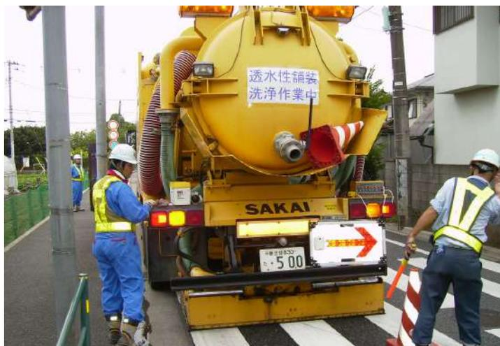
写真 車道透水性舗装を洗浄する CJ500
