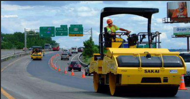
大型舗装用振動ローラ 主に高速道路などのアスファルト舗装工事で使用 アメリカ、中国等の大規模舗装工事にて需要多い
