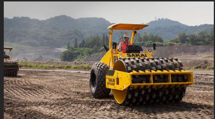
大型土工用振動ローラ 道路基礎工事、造成・ダム等の大型土木工事に使用
