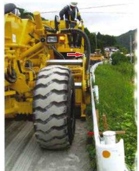
Desplazamiento lateral del rotor
