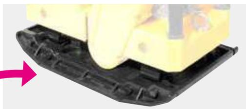
Se puede ajustar el ancho de compactación mediante placas de extensión. (Aumentar en 155 mm / 6.1 in.)
