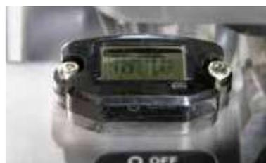
Contador de horas/Tacómetro
